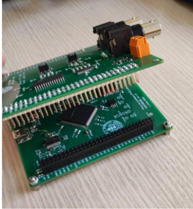
Figura 3.7: Vista de la placa prototipo enganchando con la placa FPGA
