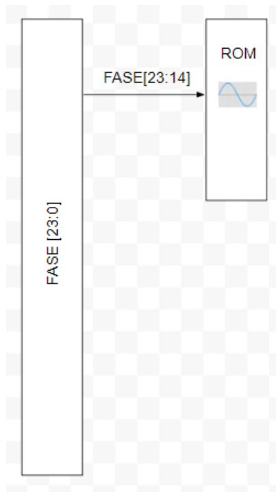
Figura 4.13: Esquema para visualizar los bits usados por la ROM
