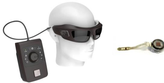
Figura 10: Elementos de la prótesis retiniana IRIS ® II. Pixium Vision.
