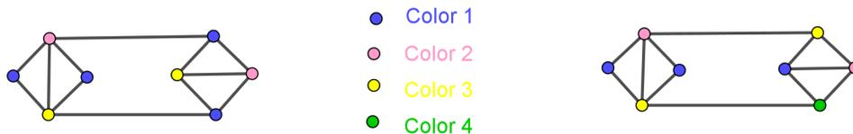
Figura 3.12: A la izquierda una coloración óptima de un grafo, y a la derecha la coloración obtenida con  $DSatur$ .
