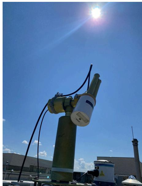
Figura 2.1: CIMEL CE318, de la Universidad de Valladolid realizando medidas de la radiancia del cielo.
