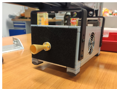
Figura 27: Fuente que produce ondas electromagnéticas a 100 GHz de frecuencia.
