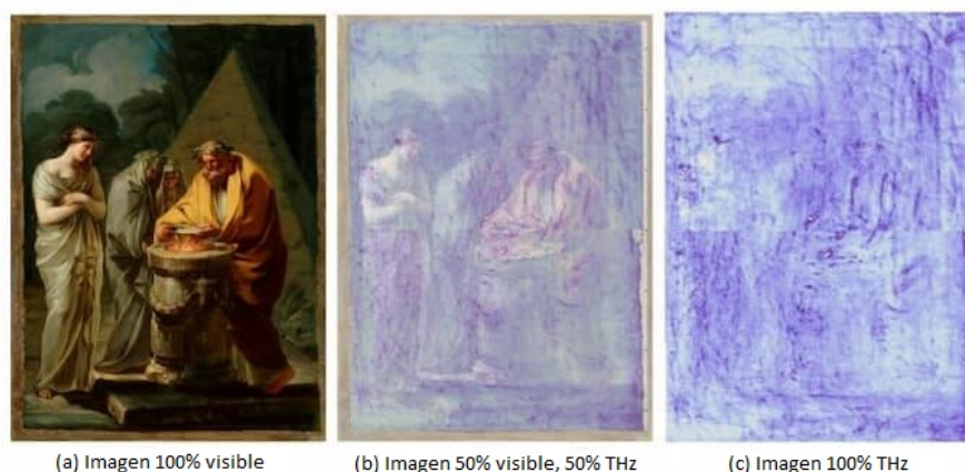
Figura 13: Análisis de un lienzo con radiación THz.
