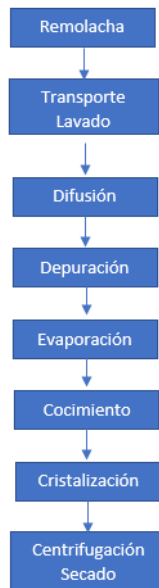
Figura 1 Diagrama general del proceso de obtención del azúcar
