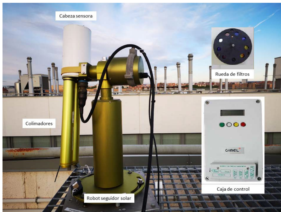
Figura 5. Componentes principales de un fotómetro solar CIMEL-318. Imagen tomada de Velasco Merino (2020).
