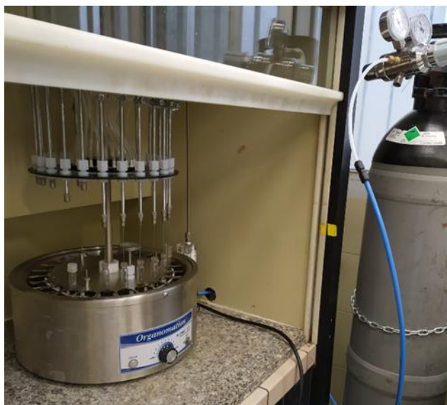
Figura 12: Evaporador bajo corriente de nitrógeno
