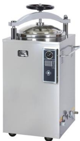
Figura 10: Autoclave empleado para la hidrólisis química a la alta temperatura y presión que puede soportar el equipo
