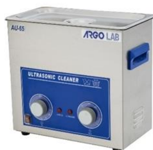
Figura 9: Baño de ultrasonidos empleado para la hidrólisis enzimática
