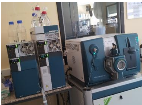
Figura 13: Equipo empleado en la determinación cromatográfica UHPLC-MS/MS
