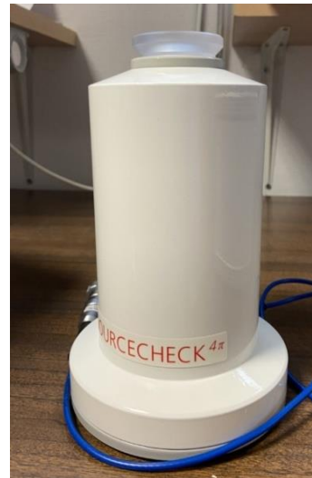
Figura 7: Cámara de pozo PTW SOURCECHECK (4 \pi ).
