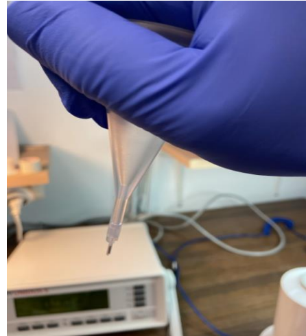
Figura 9: Fuente junto al inserto en su correcta posición para su medida.
