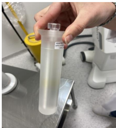
Figura 11: Inserto destinado para calibración de fuentes de alta tasa: T33004.1.014.
