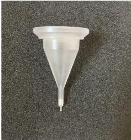
Figura 8: Inserto usado para medida de fuentes oftalmológicas: T33005.1.100. Adaptador para semillas individuales.
