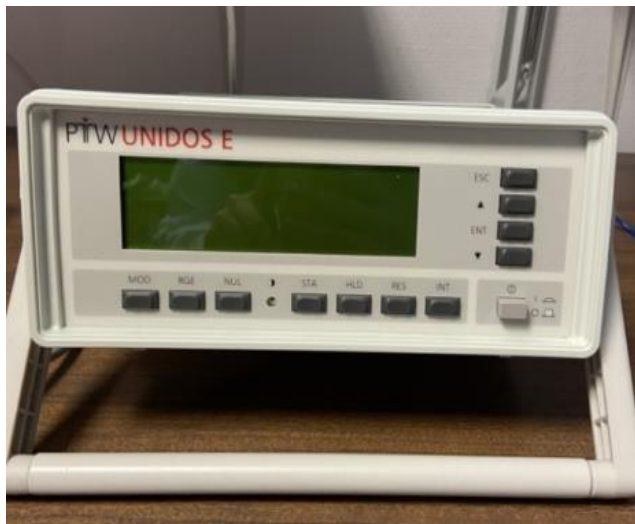
Figura 6: Electrómetro PTW UNIDOS E (PTW TM33005 sn 121655).
