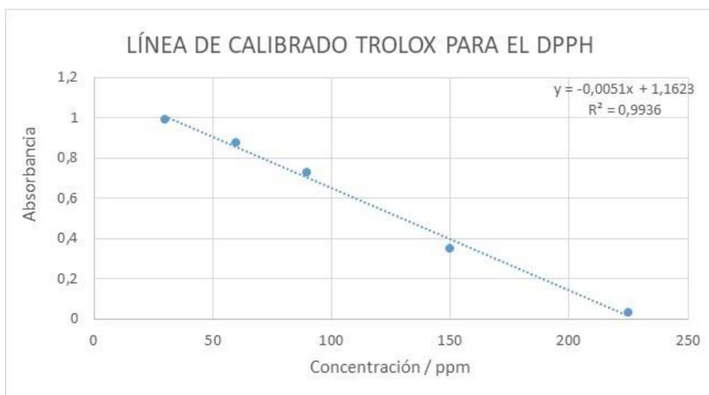
**Figura 11: Línea de calibrado con Trolox para el DPPH**
