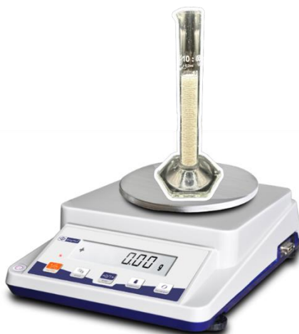
Figura 24: Equipo experimental necesario para medir la densidad aparente del producto, consta de una probeta de 10 mL y una balanza analítica.
