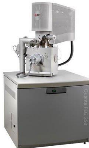
Figura 25: Imagen del microscopio con el cual se han obtenido las micrografías que se muestran en el ANEXO de este trabajo, el QUANTA 200 FEG, Hillsboro, Oregon, USA.
