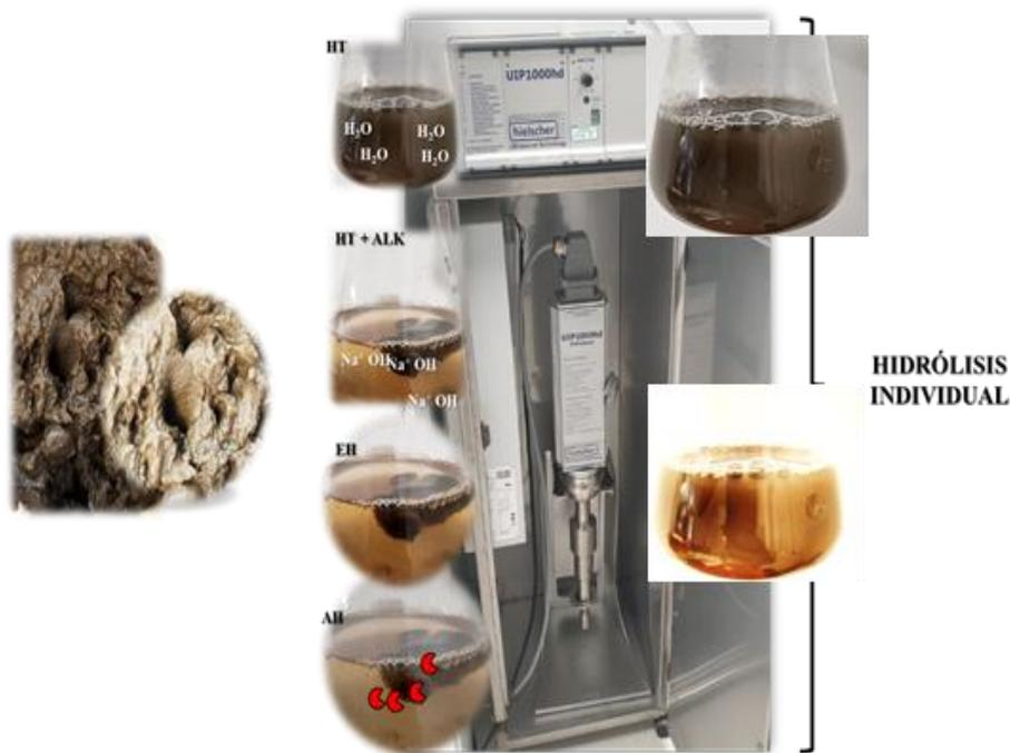
**Figura 10:** Experimentación del proceso secuencial en dos etapas de ultrasonidos seguido de hidrólisis
