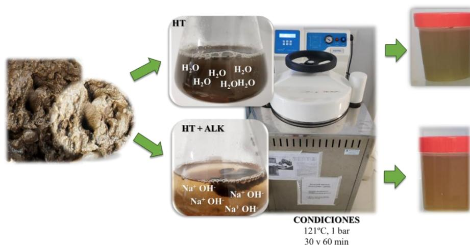
**Figura 12:** Experimentación de hidrólisis hidrotérmica (HT) y combinación hidrotérmica+alcalina (HT+ALK) a la suspensión del 4% de biomasa BS.
