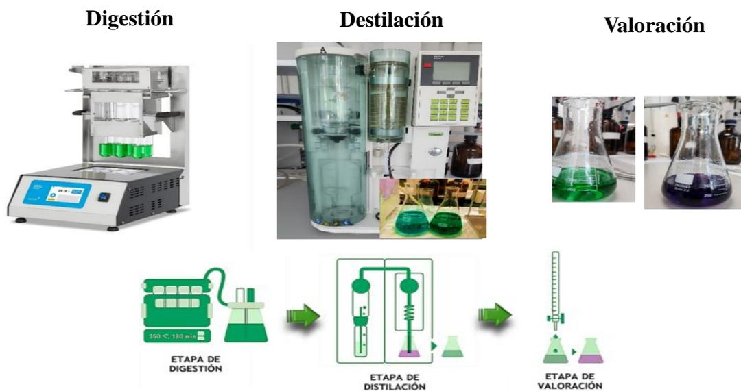
**Figura 14:** Esquema y equipo experimental para la determinación de proteínas por el método NKT
