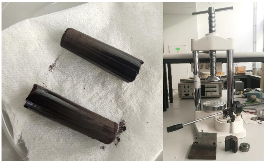
Figura 2.3. (Izquierda) Piezas compactas con forma de cilindro. (Derecha) Prensa y moldes empleados
