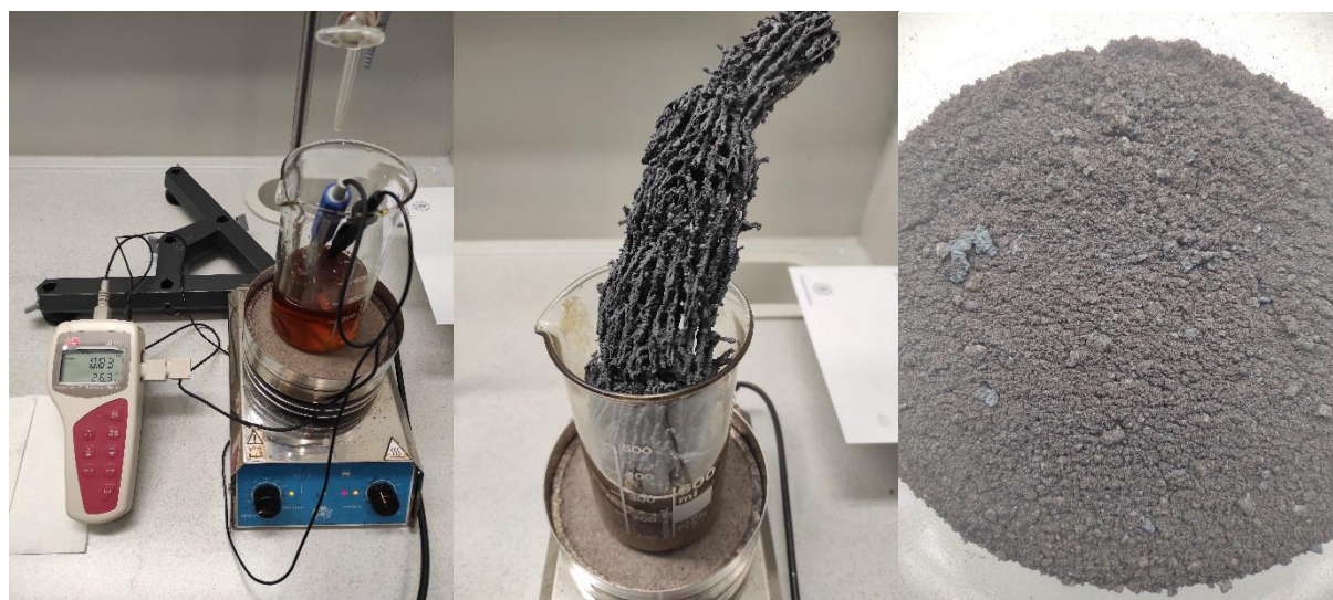
Figura 2.1. Método de autocombustión sol-gel. (a) Calentado y agitación de la disolución, mientras se controlan la temperatura y el pH. (b) Columna de material tras la combustión. (c) Polvo sin sinterizar.
