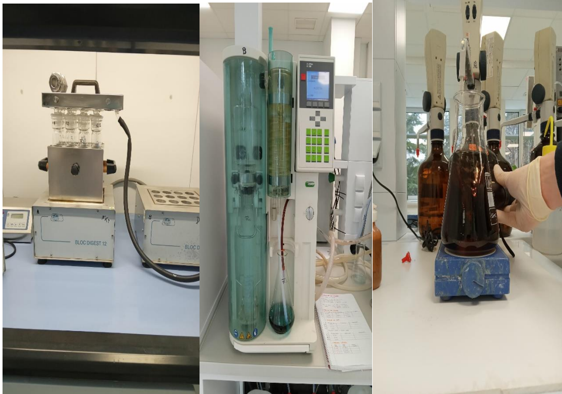
Figuras 4.2A, 4.2B y 4.2C: Equipo digestor A, equipo de Destilación B y valoración de la muestra.
