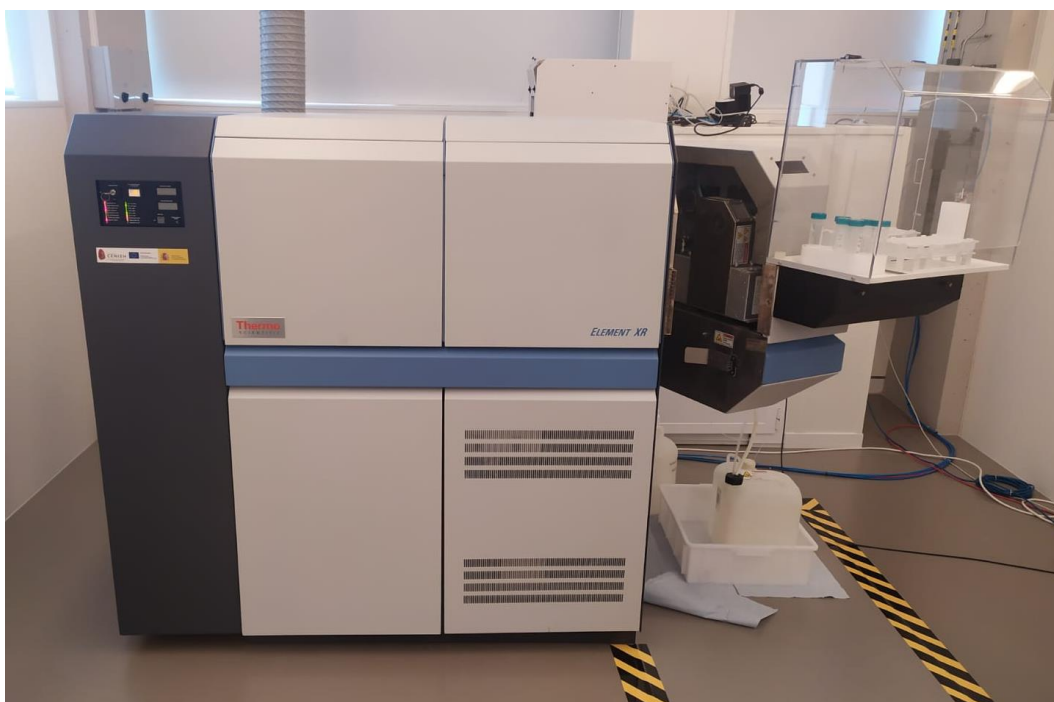
Figura 2. Espectrómetro HR-ICP-MS usado en este trabajo. U-Series Lab, CENIEH
