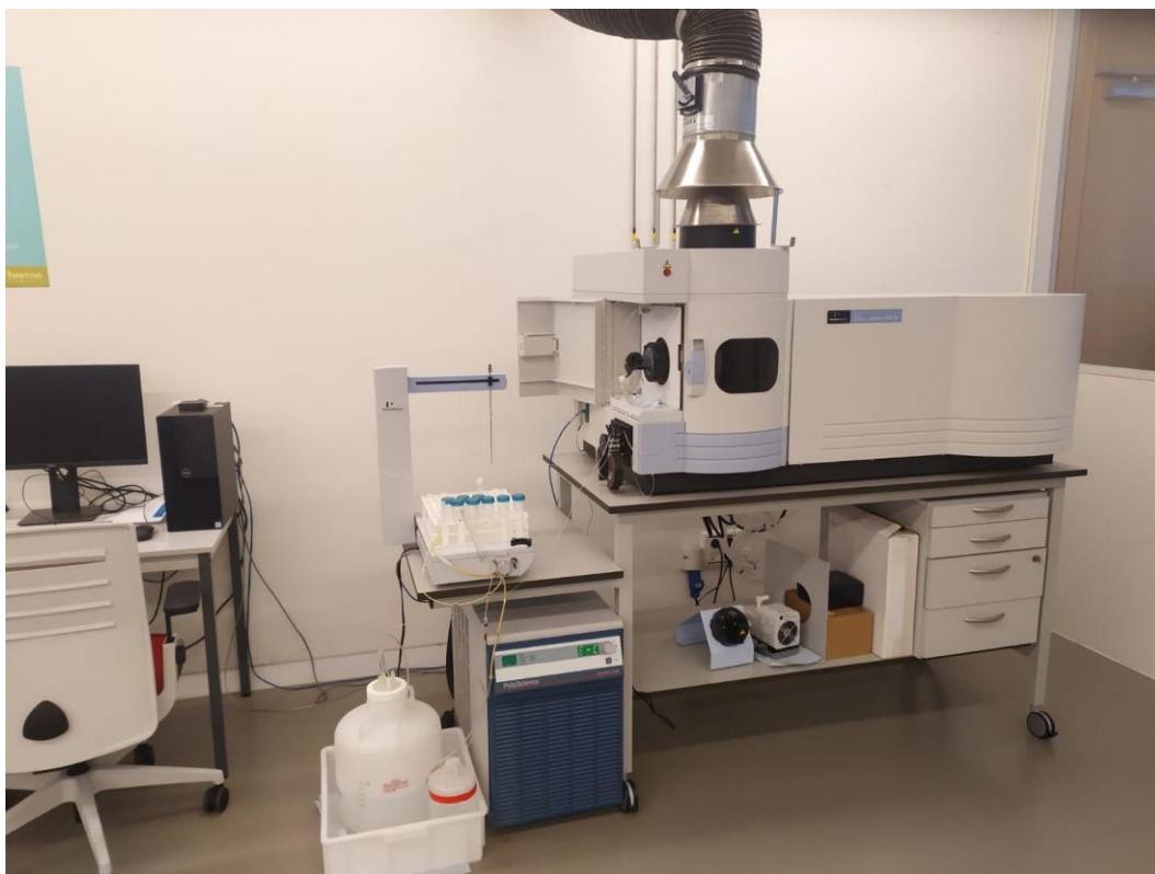
Figura 1. Espectrómetro ICP-OES usado en este trabajo. U-Series Lab, CENIEH.
