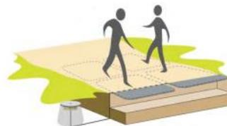
*Ilustración 17: Aforador peatonal bidireccional*
