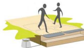
Ilustración 18: Aforador peatonal bidireccional
