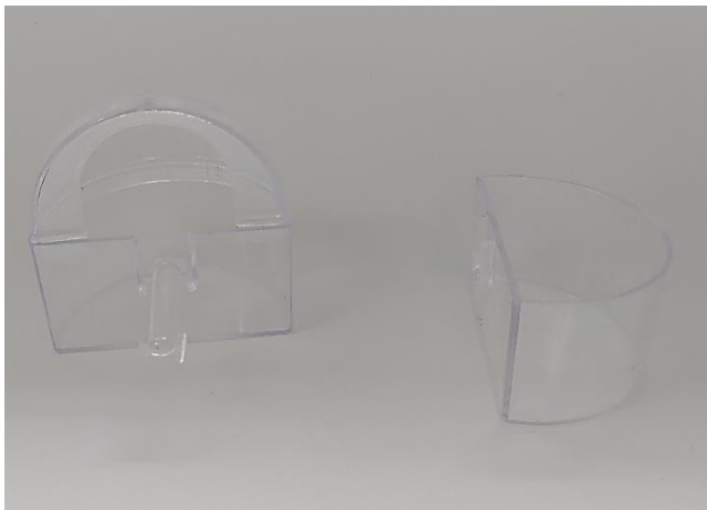
Imagen 4: Comedero de aves domésticas (derecha). Cubeta semicilíndrica (izquierda) elaborada a partir de un comedero de aves domésticas.
