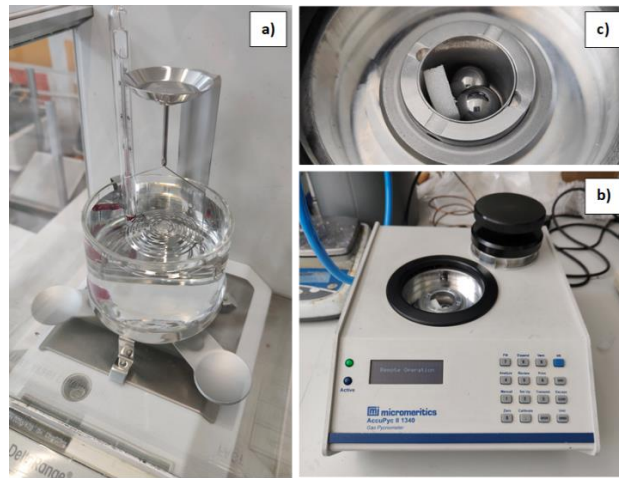
Figura 14: a) Balanza de precisión con los accesorios para poder medir densidad por Arquímedes. b) Picnómetro. c) Cámara interior del Picnómetro con diferentes calas.
