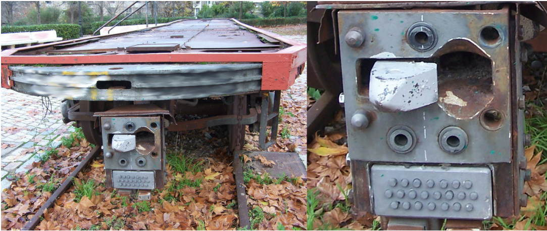
Figura 41: Vista general y detalle de un antiguo coche de Metro de Madrid usado como escenario y situada en el parque Tierno Galván (Distrito de Arganzuela). En la parte inferior hay tres filas de conexiones eléctricas, los agujeros son conexiones neumáticas. El hueco grande es para que el otro gancho pueda entrar.
