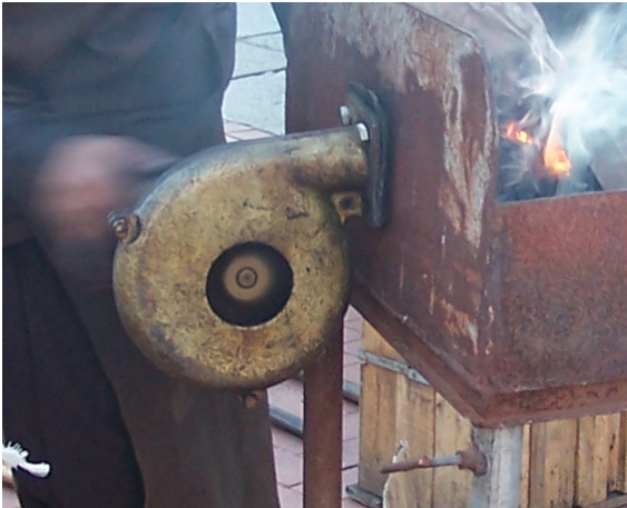
Figura 32: Bomba de aire radial situada en una fragua portátil en una exhibición.
