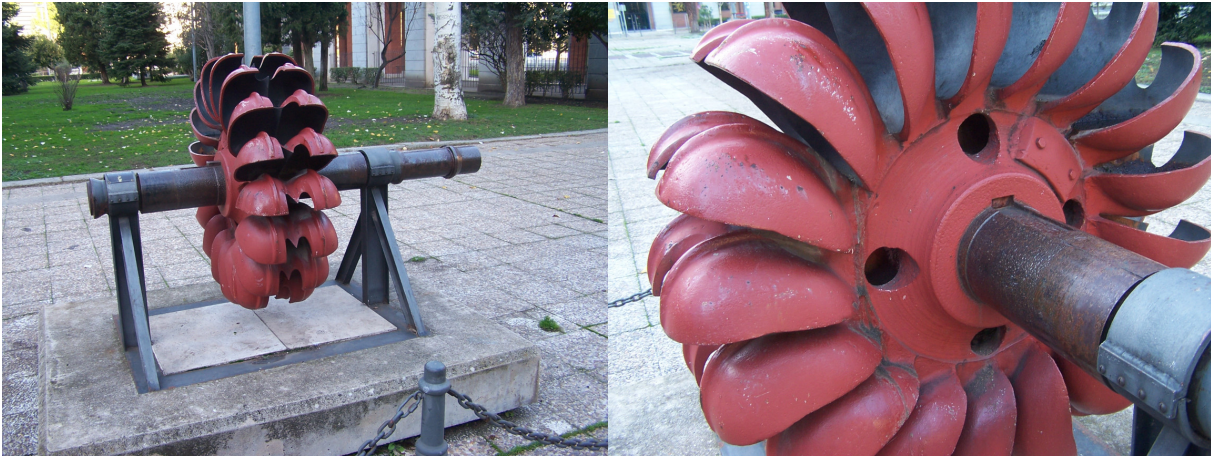
Figura 31: Turbina Pelton situada en Nuevos Ministerios, Madrid.
