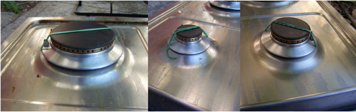
Figura 37: Ejemplo de una cocina con tres fogones de varios tamaños, por el hueco inferior entra aire permitiendo que por los agujeros pequeños salga gas con algo de aire mezclado para mejorar la combustión. La pieza blanca a la izquierda del fogón grande es el encendido (genera una chispa que enciende el gas) y la barra fina es un sensor de seguridad para cortar el gas si no hay llama.
