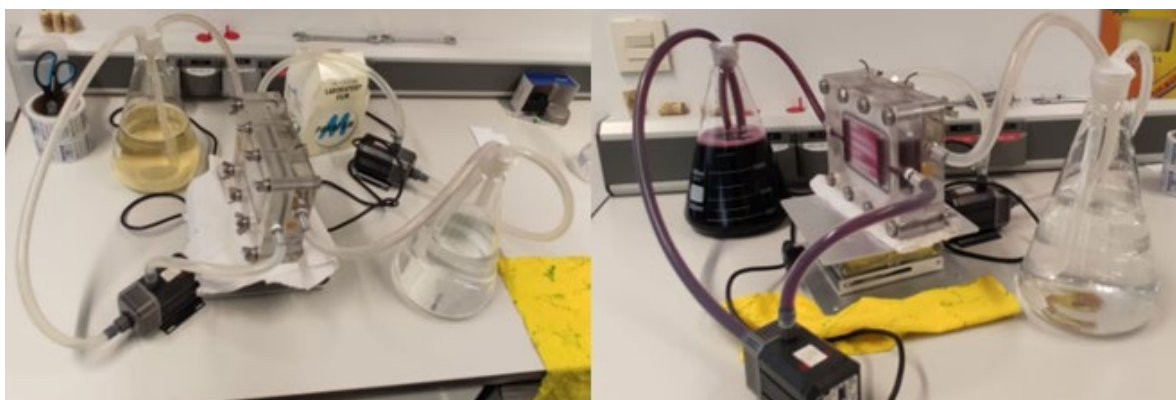
Figura 3 - Imagen del equipo de diálisis funcionando para vino blanco (izquierda) y vino tinto (derecha). (Fuente propia)
