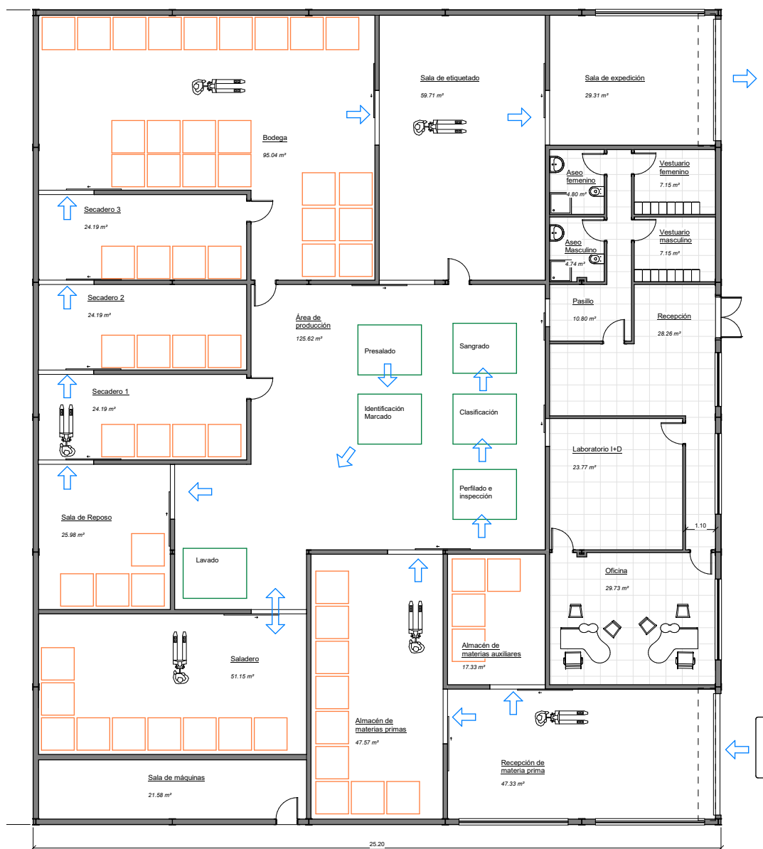
Figura 3. Diseño en planta de la industria destinada a la elaboración de jamones blancos curados
