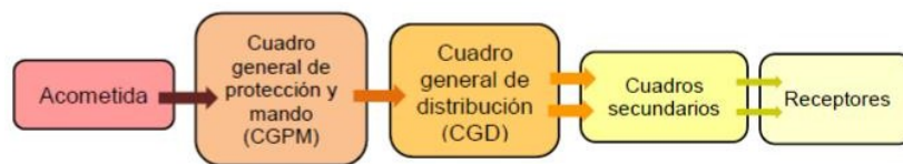
Ilustración 1. Red de instalación eléctrica
