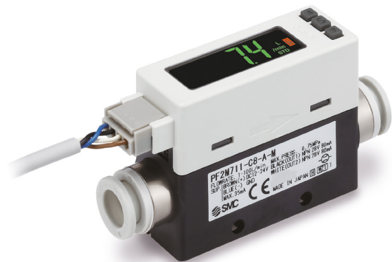
Fig 13.3: Flujoestado térmico digital SMC PF2M7 para la medida de gases, capaz de escoger el tipo de gas entre aire, N 2 , Ar, CO 2 y sus mezclas
