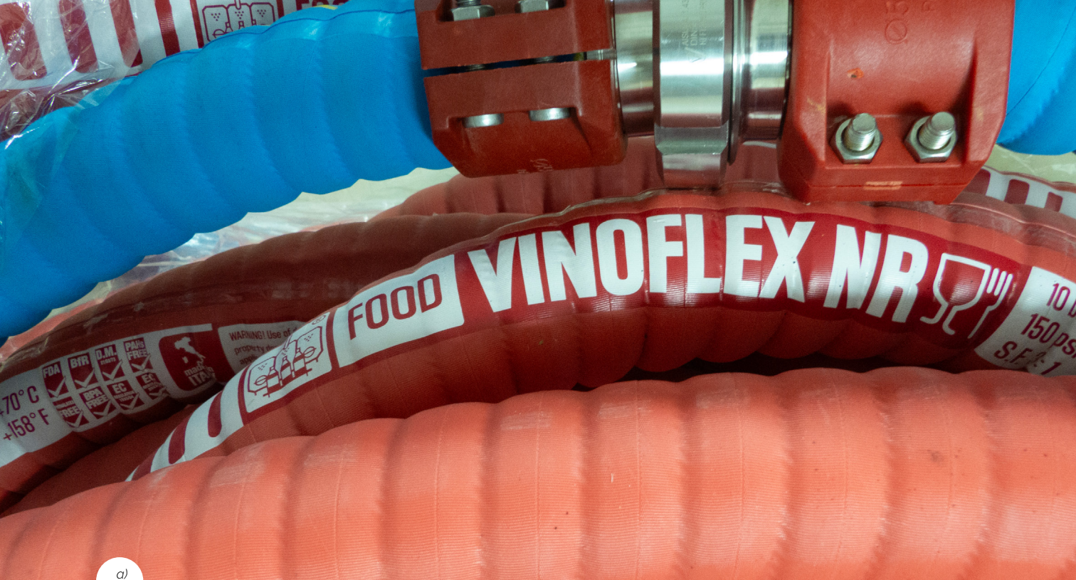
Fig. 5.2. (a) Detalle de las mangueras con el conector DIN 11851; (b) Vista del anillo de caracterización de las mangueras de diferentes materiales
