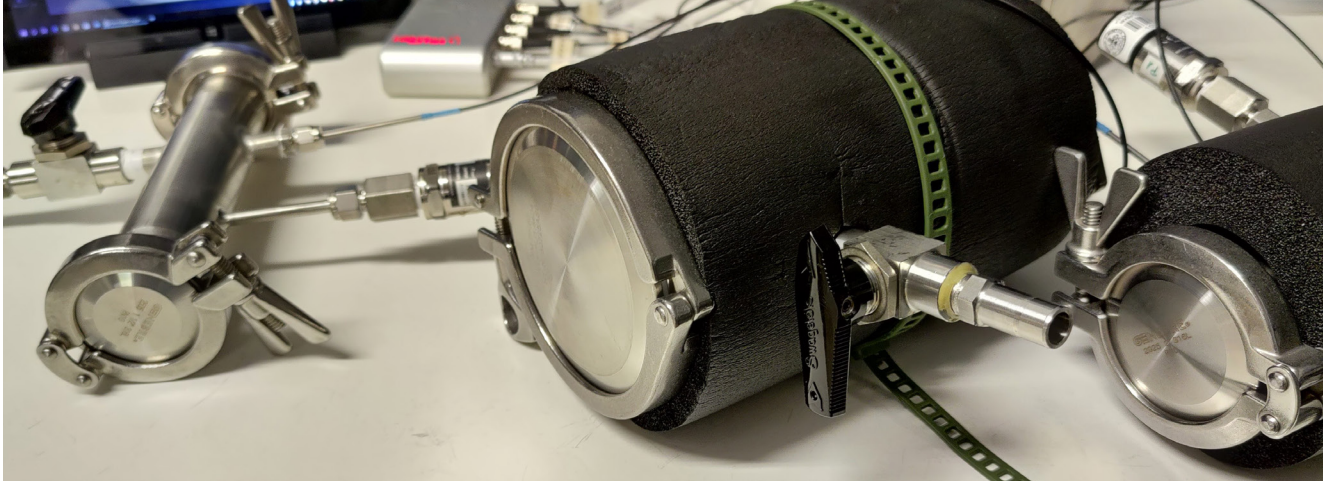
Fig. 5.3. Detalle de los tres tamaños de conectores CLAMP ensayados (DN32, DN50 y DN80) con ambas tapas ciegas y en los que se ensayó la OTR para dos juntas
