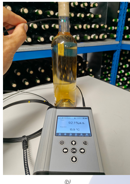
Fig. 10.7. Detalle de la posición de dos sensores para medir el oxígeno disuelto en espacio de cabeza y en el vino de la botella (a) y detalle de la medida del oxígeno disuelto en el vino (b)
