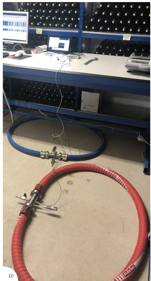
Fig. 5.2. (a) Detalle de las mangueras con el conector DIN 11851; (b) Vista del anillo de caracterización de las mangueras de diferentes materiales
