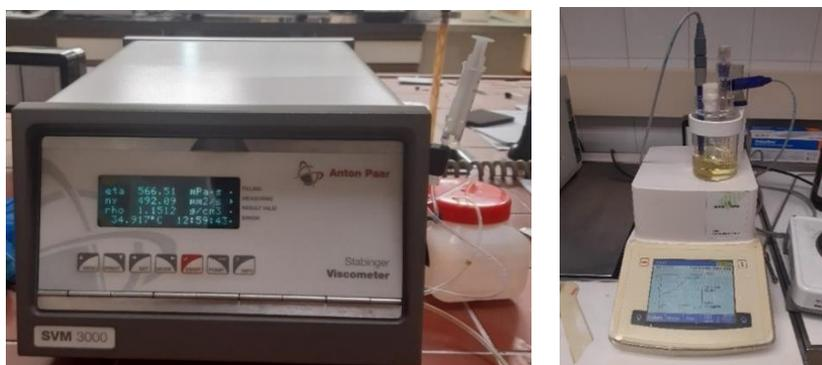
*Figura 6: Densímetro-Viscosímetro SVM 3000-Anton Paar y Valorador culombimétrico Karl-Fischer*
