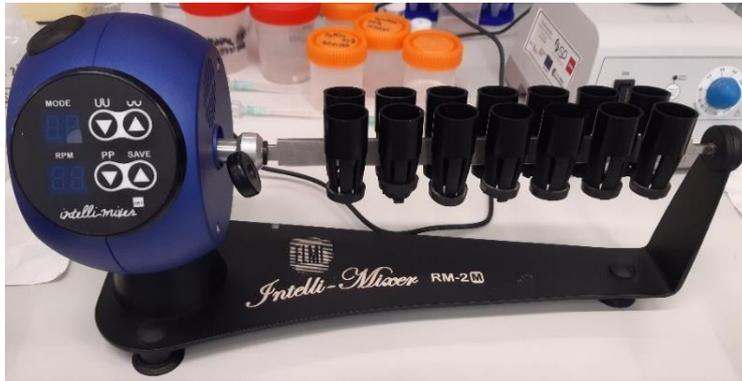
Figura 8: Rotor de brazo rotatorio
