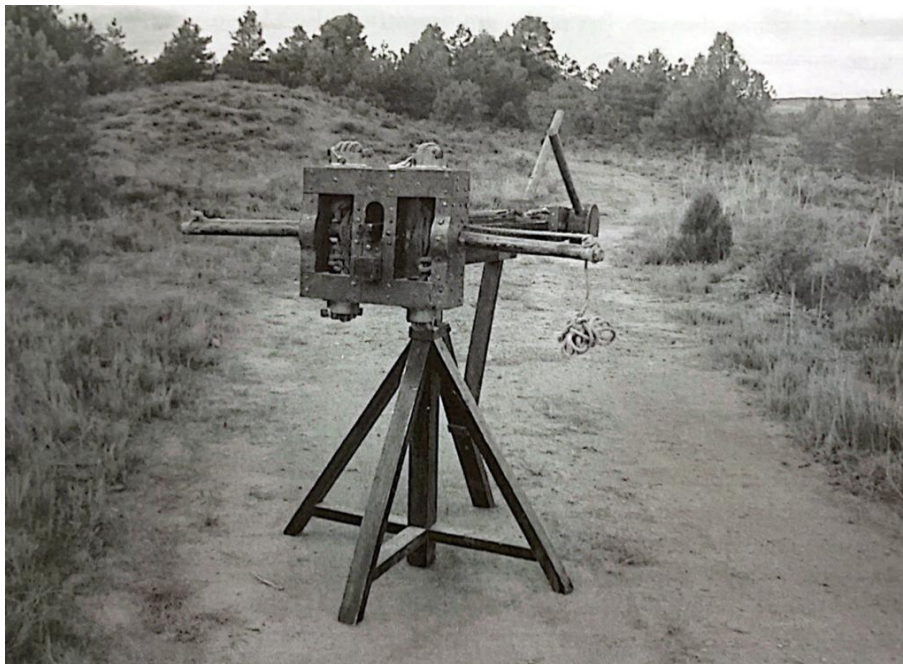
Figura 16. Representación de catapulta de tipo scorpium (según Sáez, 2005: fig. 84).
