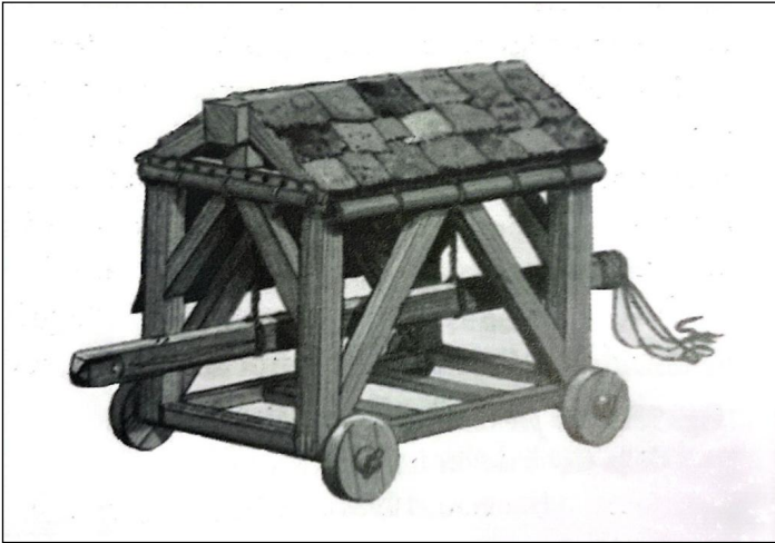
Figura 3. Modelo de ariete móvil. Se impulsaba mediante cuerdas (Sáez, 2005: fig. 50).
