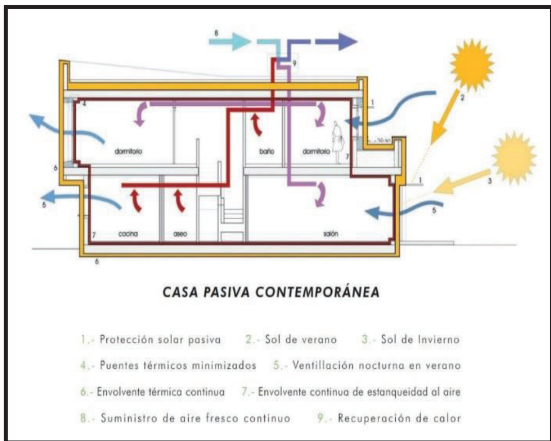
Figura 25 Funcionamiento de una vivienda Passivhaus
