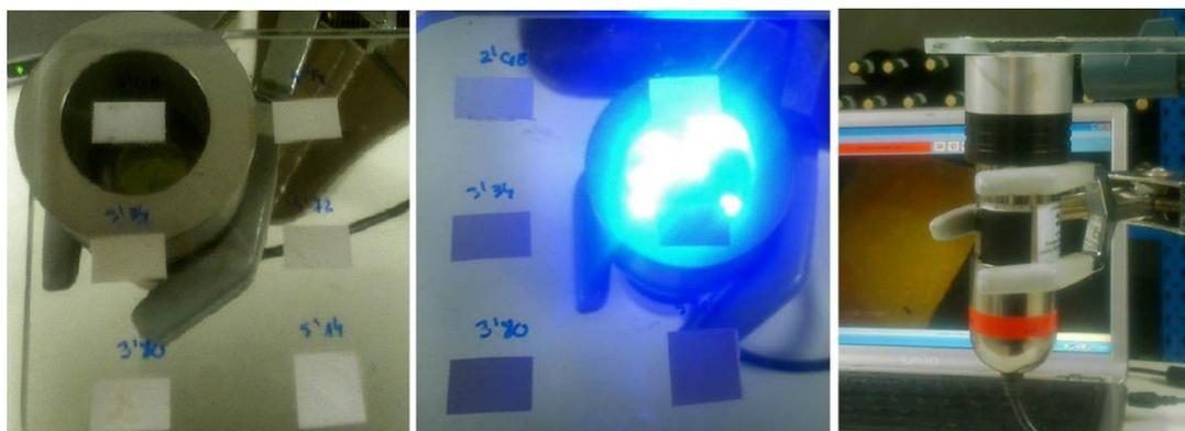
**Figura 9:** Detalle de los sensores en los que se depositan las diferentes soluciones patrón y después de estabilizadas durante tres horas se captura una imagen con la cámara-detector situada al otro lado del soporte (cristal) transparente.
