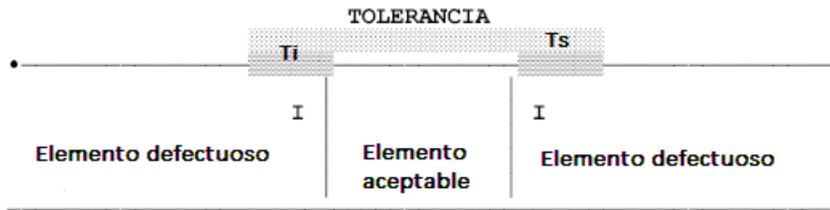
Fig.2.2. Elementos aceptables y defectuosos.
