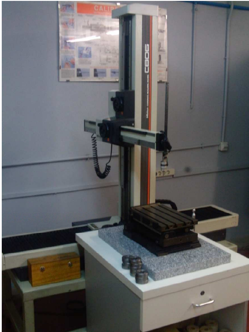
Fig. 4.43. Máquina de medida por coordenadas 3D.
