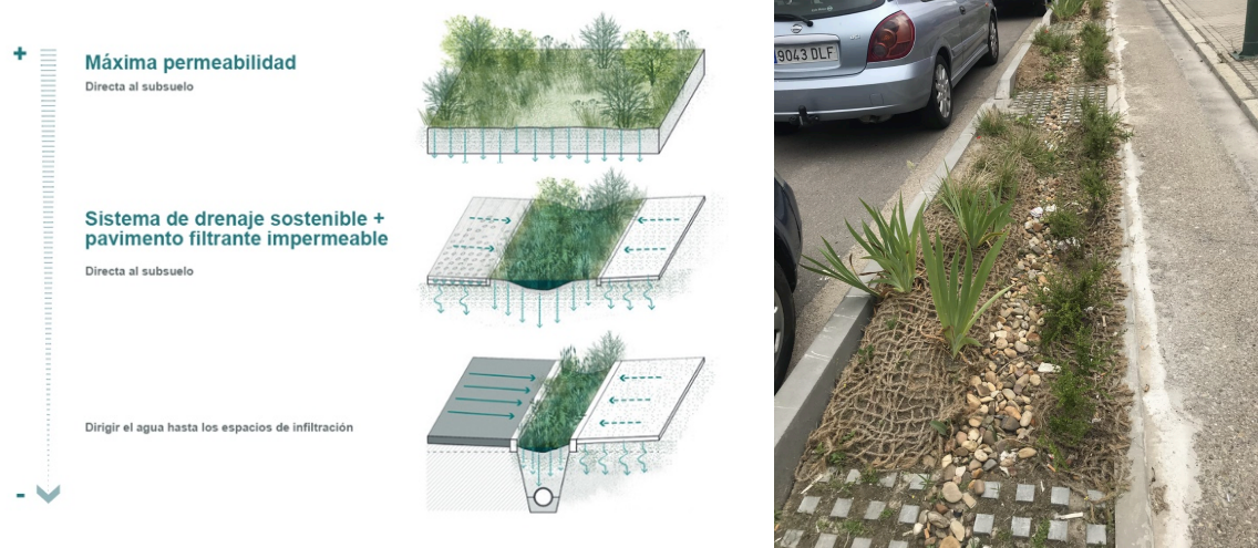
Figs. 11 y 12. A la izquierda: diferentes soluciones de cuneta verde. A la derecha: cuneta verde en Argales, con filtración directa al subsuelo y realizada a base de gravas de diverso calibre Diferentes. Fuentes: Claudia Sánchez Escudero (UVa), a partir de Montlleò y Spanou (2022) y M. Rosario del Caz Enjuto (UVa).
