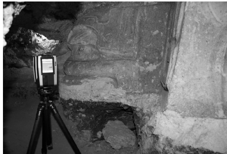
Figura 4. El Mascarón de Chilonché durante el proceso de documentación mediante el escáner láser Faro Focus 3D S120.
