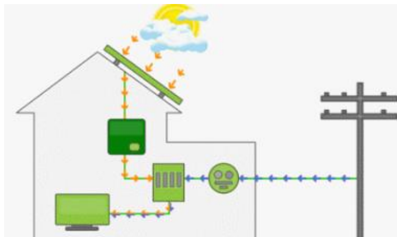
Ilustración 2. Instalación fotovoltaica híbrida. Fuente: alfaengenharia.net.br
