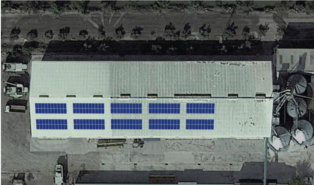
Ilustración 103. Solución adoptada. Fuente: SolarEdge, elaboración propia.
