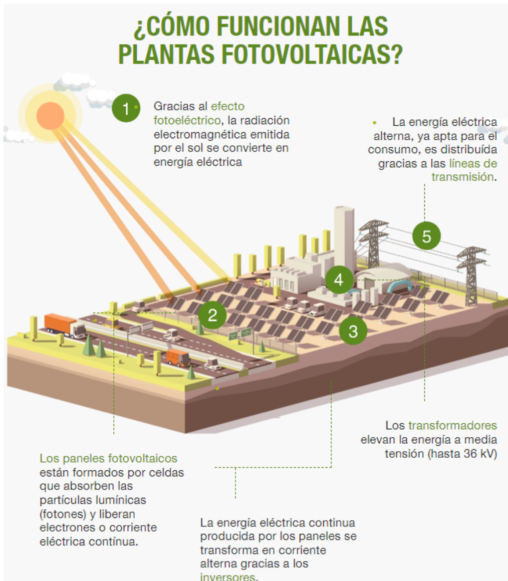
Ilustración 16. Esquema de planta solar fotovoltaica. Fuente: Iberdrola. [23]
