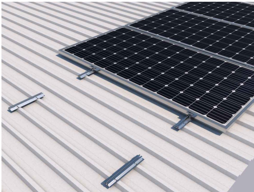
Ilustración 74. Disposición final de paneles. Fuente: Sunfer.
