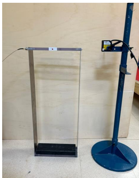
Figura 70: Colocación del sensor láser y el acelerómetro para medir desplazamientos horizontales
