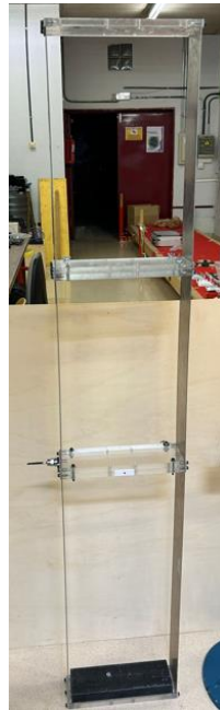
Figura 122: Estructura de 3 gdl sin masas
