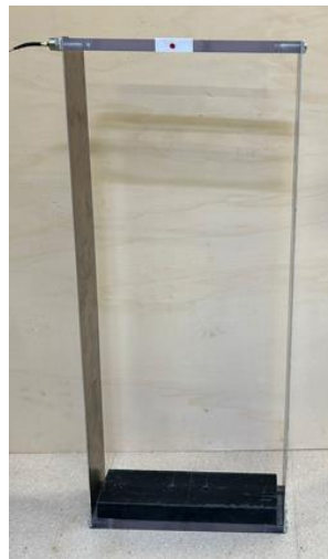
Figura 72: Estructura de 1 gdl sin masas
