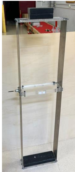
Figura 112: Estructura de 2 gdl con dos masas de 25/8 kg
