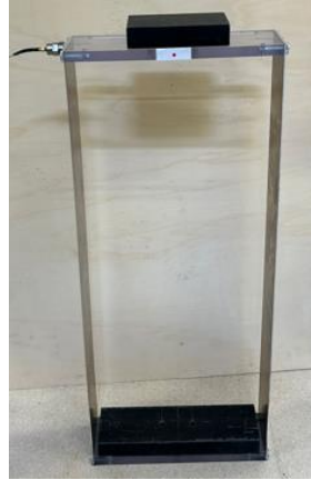
Figura 80: Estructura de 1 gdl con masa de 25/8 kg
