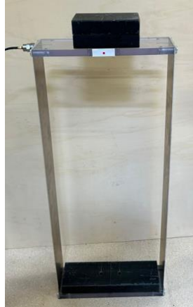
Figura 88: Estructura de 1 gdl con dos masas de 25/8 kg
