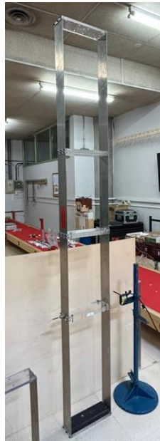
Figura 132: Estructura de 4 gdl sin masas
