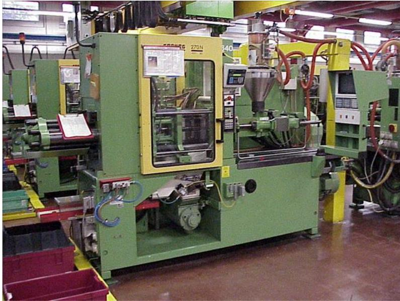
Figura 2. Máquina de inyección de molde de LEGO, empresa Arburg [1]
