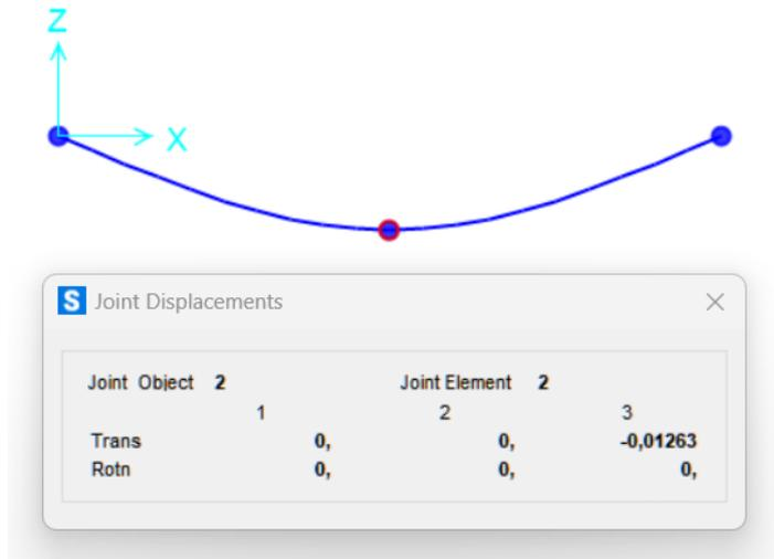
Figura 106. Deformada generada por la acción de dos cargas centrales
