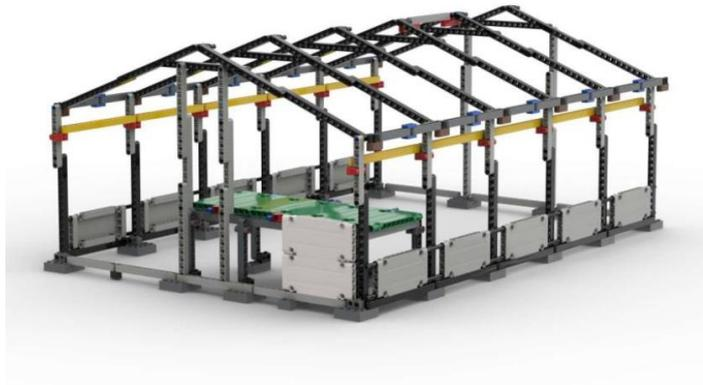
Figura 11. Modelo digital de una nave [12]
