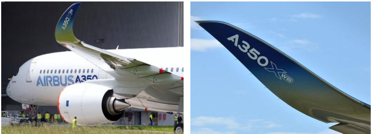
Figura 26. Ala del Airbus A350-900 [8]
