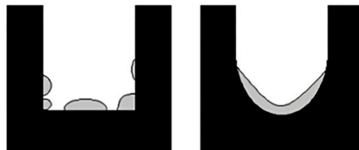
Figura 25. Acumulaciones de agua según tipo de sección de canales [25]
