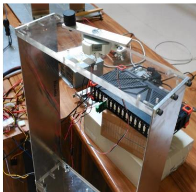
Figura 6. Excéntrica acoplada a un motor generadora de fuerza centrífuga. [6]
