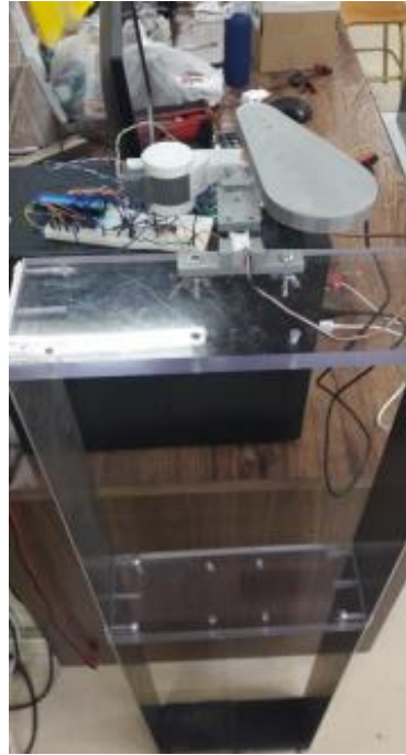
Figura 9. Excitación producida por la excéntrica en el segundo piso. [8]
