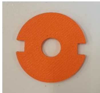
Figura 85. Hendiduras en la base del engranaje superior.
