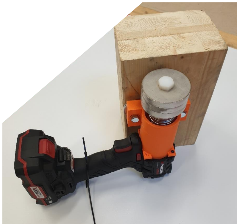
Figura 89. Impactador fijado a la estructura.
