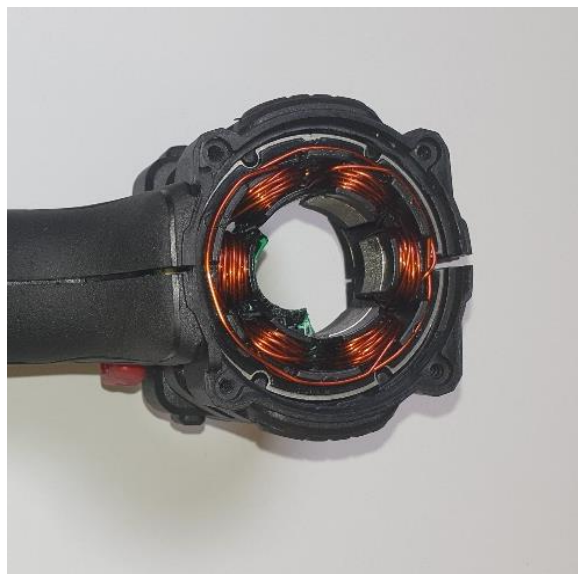
Figura 27. Estator formado por las bobinas.
