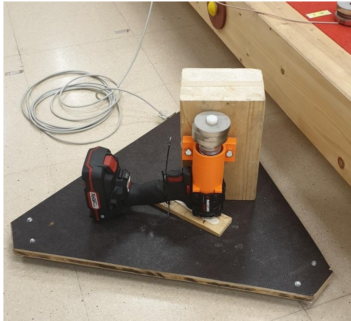
Figura 91. Force Plate: Báscula registradora de la fuerza de impacto.
