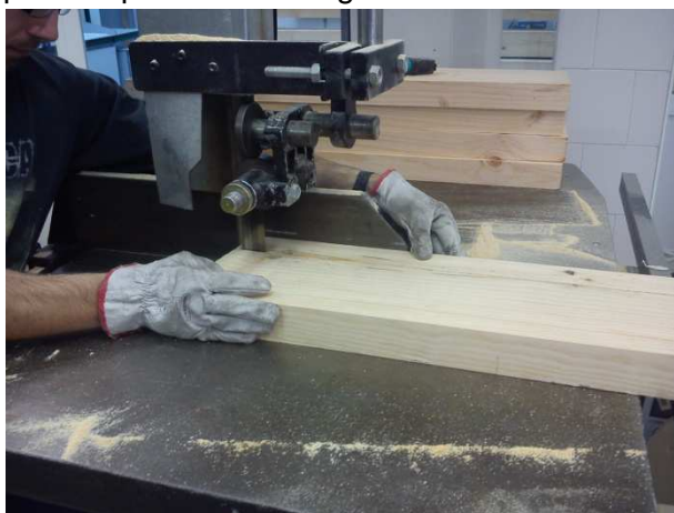
Figura 4.1. Detalle del corte realizado sobre madera de P. x euramericana I-214 con la sierra de banda. (Fuente: Propia).
