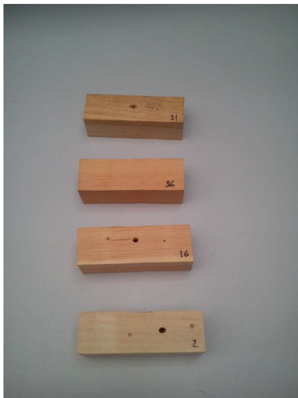
Figura 4.2. Probetas de las especies Quercus pyrenaica , Pinus pinaster , Pinus sylvestris , y Populus x euramericana I-214 ordenadas de arriba a abajo. (Fuente: Propia).
