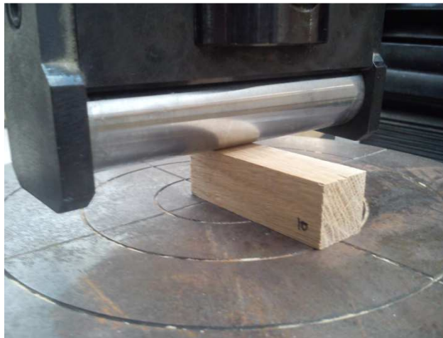
Figura 4.6. Ensayo de dureza sobre probeta de Populus x euramericana I-214 . (Fuente: Propia).
