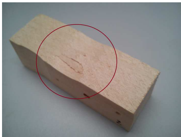
Figura 4.7. Detalle de la huella en una probeta de Populus x euramericana I-214 tras un ensayo de dureza. (Fuente: Propia).
