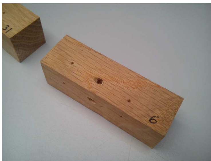
Figura 4.9. Detalle perforación con Pilodyn 6J Forest en probeta de Quercus pyrenaica . (Fuente: Propia).
