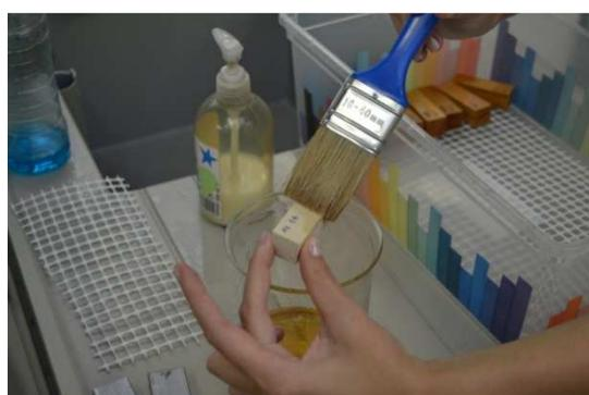
**Figura 4.10.** Pincelado de las probetas con aceite para teca tras su lijado (Fuente: propia)
