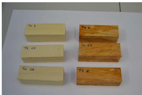
Figura 4.6. Vista de 3 de las 26 probetas ensayadas a 160°C (Fuente: propia)
