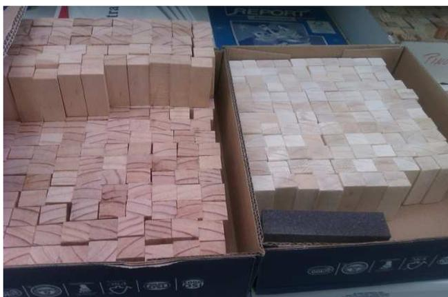
Figura 4.1. Probetas de madera a ensayar (Fuente: propia)
