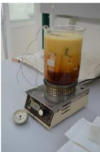
**Figura 4.9.** Inmersión de las probetas a 140°C durante 30 minutos (Fuente: propia)
