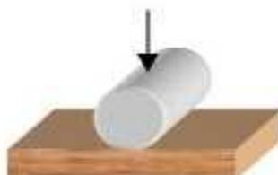
**Figura 4.13.** Esquema ensayo Monnin (Fuente: <http://normadera.tknika.net/es/content/dureza>)
