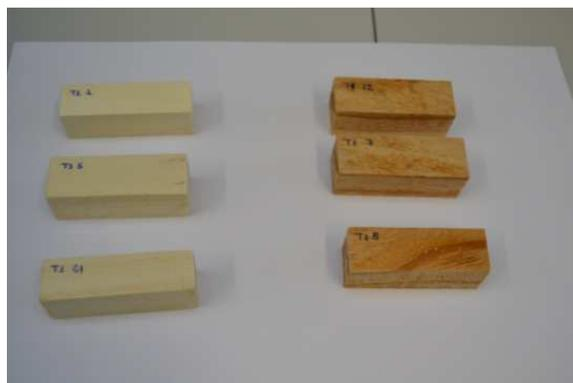
Figura 4.5. Vista de 3 de las 26 probetas ensayadas a 120°C (Fuente: propia)
