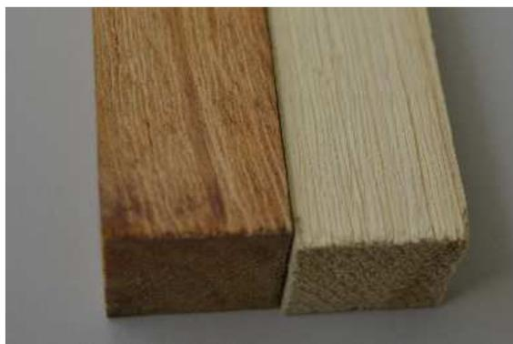
Figura 4.8. Muestra de las probetas ensayadas a 180°C y posterior lijado (Fuente: propia)
