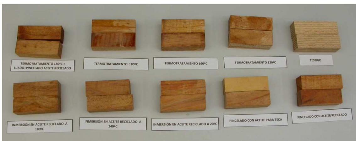
Figura 4.12. Color adquirido por la madera tratada para la especie *Pinus pinaster*
