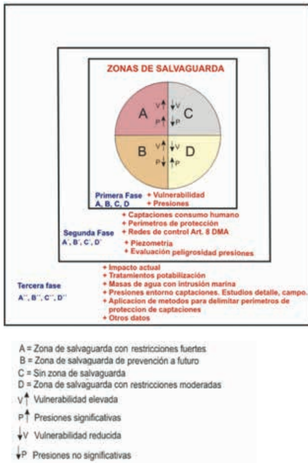
Figura 7. Fases de trabajo para la delimitación de zonas de salvaguarda y regulaciones asociadas en las masas de agua subterránea empleadas para consumo humano para su protección.
