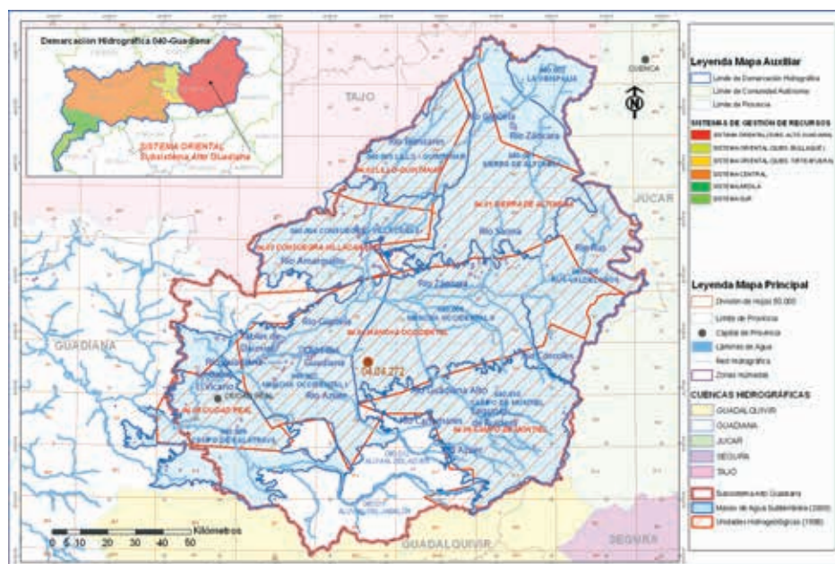
Figura 1. Mapa de la cuenca alta del río Guadiana, con la división en unidades hidrogeológicas y masas de agua subterránea.
