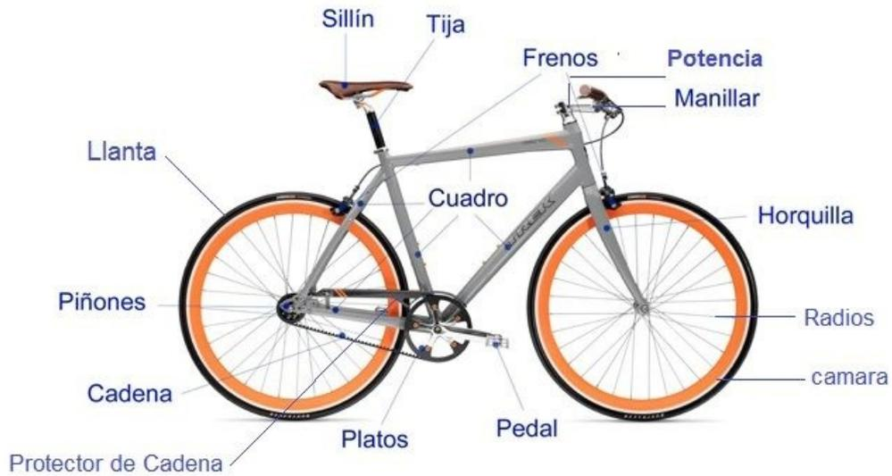
*Figura 1: Las partes de una bicicleta*
