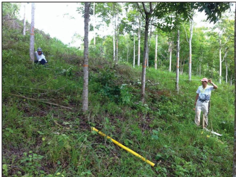
Foto 1. Corrección de la distancia en terreno inclinado por el “método del banqueo”
