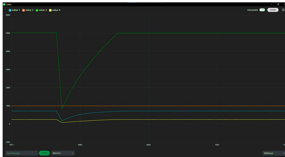
Ilustración 70. Respuesta del sistema sin Onda Cuadrada con Anti-Windup.
