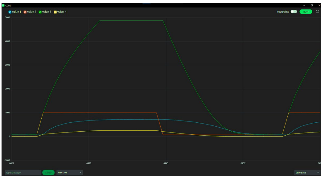
Ilustración 69. Respuesta del sistema con Onda Cuadrada con Anti-Windup
