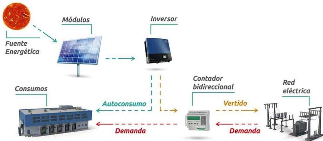
En la "imagen 5" podemos observar el funcionamiento del sistema de vertido de excedentes. Aprovechando el total de la energía producida por los módulos fotovoltaicos, cogiendo de la red en los momentos que esto fuera necesario y vertiendo a la misma en los casos de que haya excedentes.
