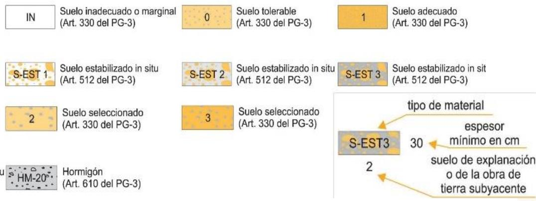
Figura 1 Formación de la explanada (Dirección General de Carreteras, 2003)
