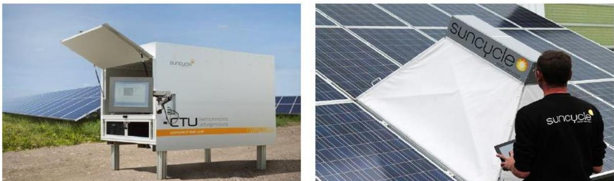
Figura 10. Inspección de EL empleando laboratorios móviles y un bloqueador de la radiación solar. Fuente: [3]
