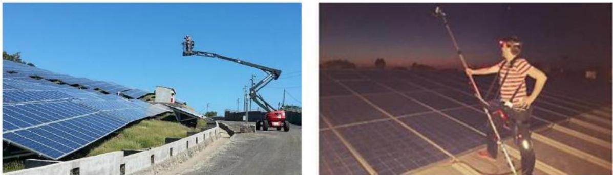
Figura 9. Inspección de EL empleando grúas y otras herramientas. Fuente: [3]
