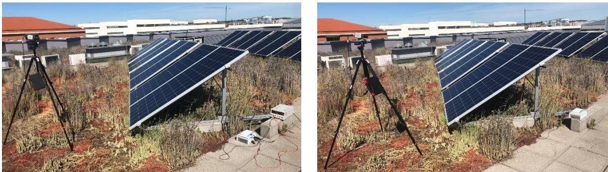
Figura 71. Equipo de medida de EL con fuente de alimentación (izquierda) y mediante el inversor bidireccional (derecha). Fuente: Elaboración propia.
