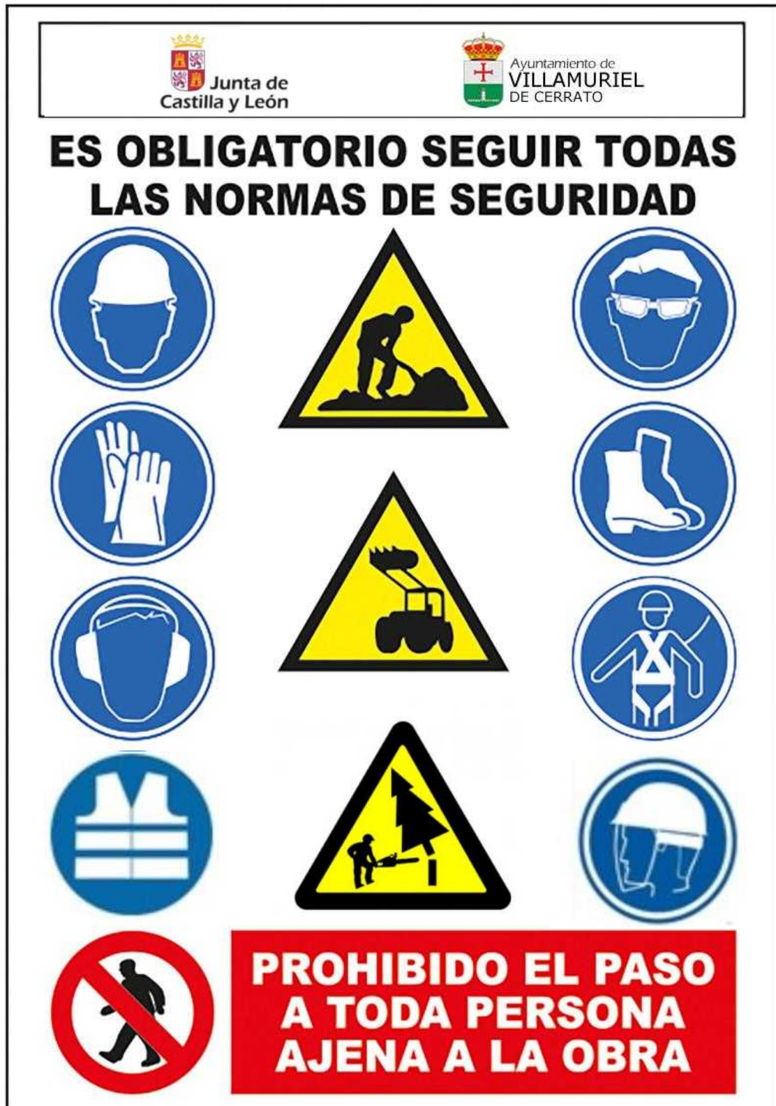
Imagen 3: Señalización de obligatoriedad de los EPI en la obra. Fuente: elaboración propia.
