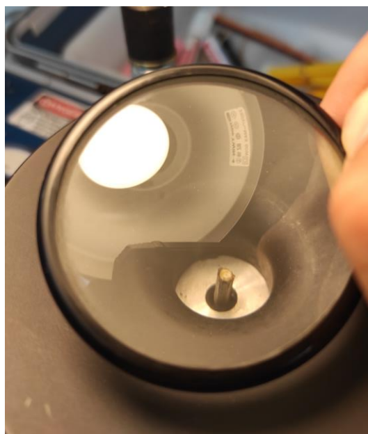
Figura 13. Introducción de tallo de planta en cámara Scholander para medida del potencial hídrico.
