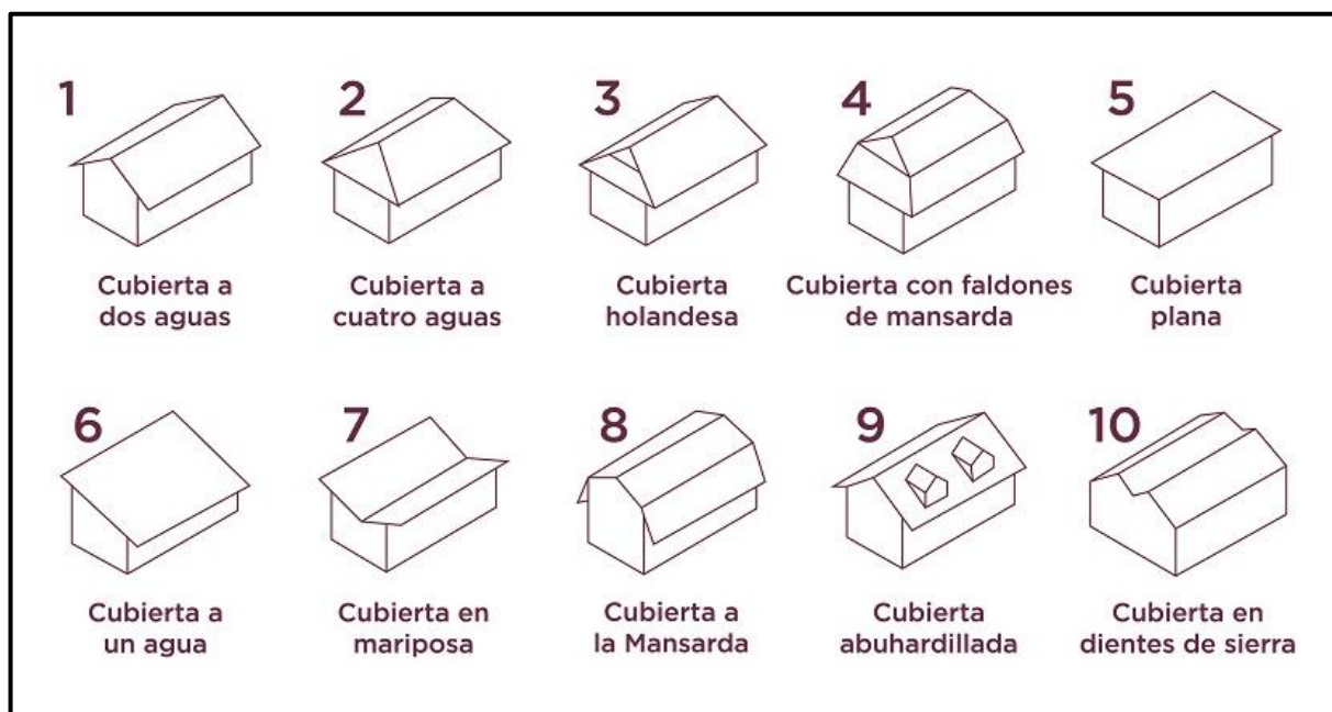
Figura 20. Tipos de cubierta según su forma. Fuente: CUPAPIZARRAS, 2023.
