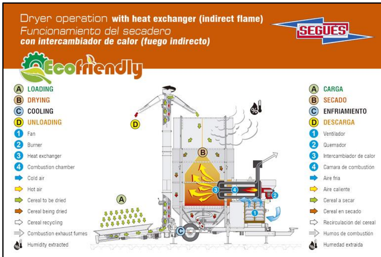
Figura 23. Funcionamiento del secadero móvil PRT 200. Fuente: Segúes, 2019.
