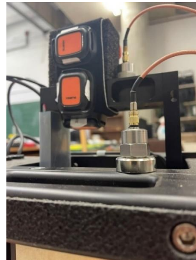
Figura 9. Shaker con XSENS y acelerómetro piezoeléctrico
