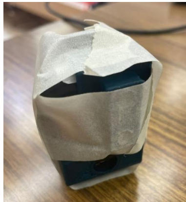
Figura 17. Montaje XSENS para calibración interna endurecido con cinta adhesiva.
