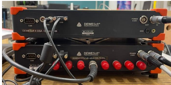
Figura 7. Tarjetas de adquisición de datos. Modelo SIRIUS by DEWESoft [9]
