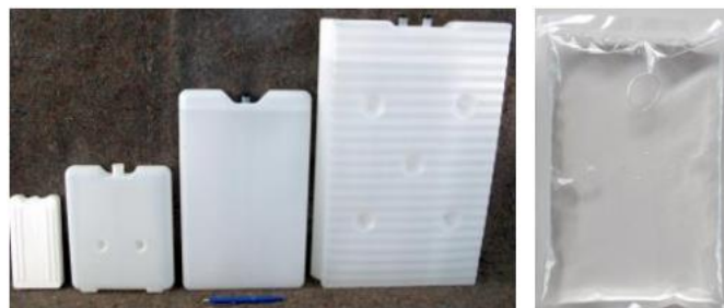
Figura 15. Envases y bolsas de plástico más utilizados en macroencapsulación. Fuente: [14]
