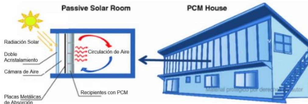
Figura 6. Caso práctico de utilización de PCM en edificación. Fuente: [14].
