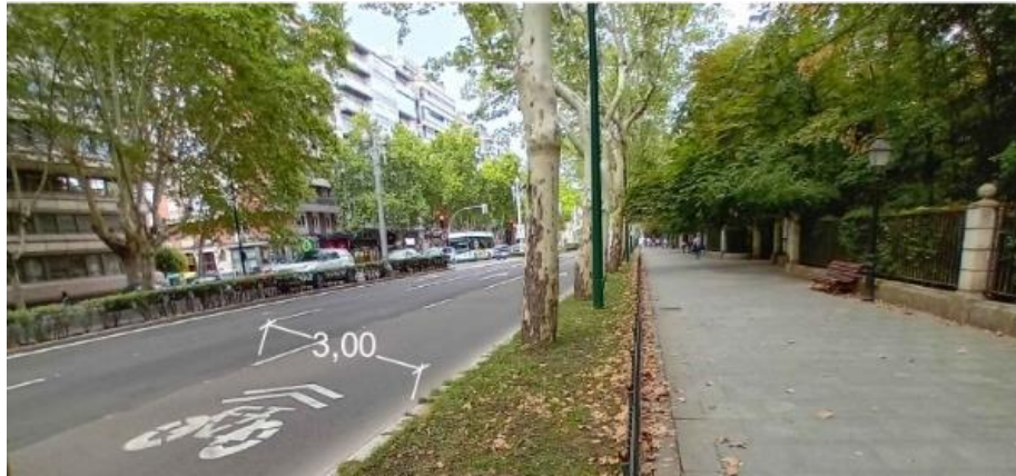
Foto 17: Ciclo-calle, carril por donde circulan vehículos a motor y bicicletas. Fotografía de la autora.
